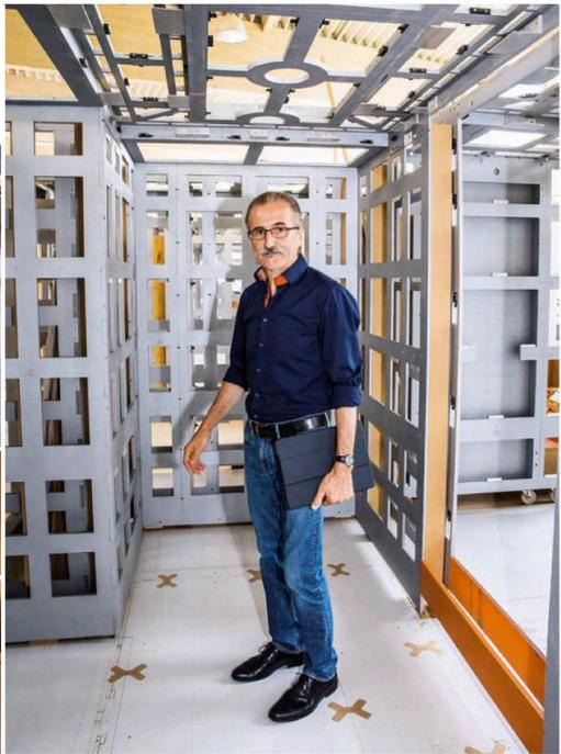
Test in Bayern: Unterkonstruktionen und Möbel baut Fitz voll funktionsfähig als Original in der Werkstatt in Meringten auf. Dann zerlegen die Monteure sie in ihre Einzelteile und setzen sie in der Yacht wieder zusammen. Diese Arbeitsweise spart auf der Werft viel Zeit.
