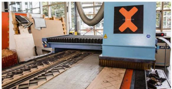
Mit dem Laserschneider lassen sich auch komplexe Holzarbeiten leicht umsetzen
